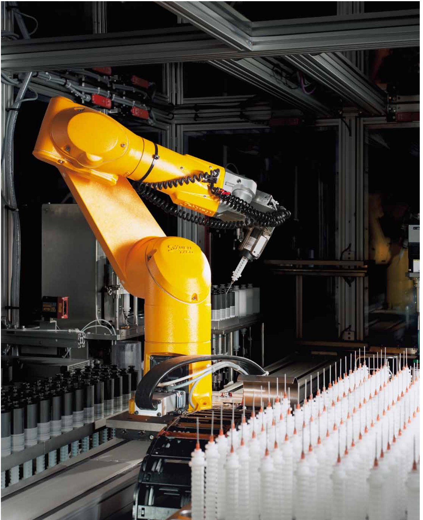
In einer Nachtschicht verarbeitet der Roboter im Kombinatoriklabor bis zu 140 Lackmixturen.
